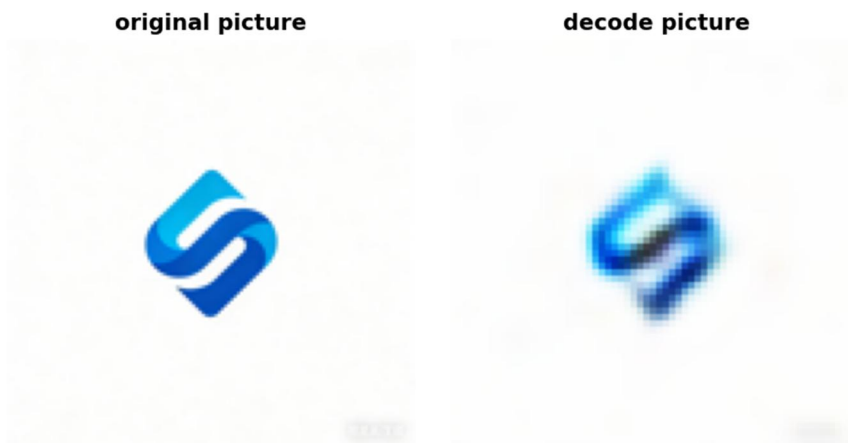
图 4.13 原始图像和解码出来的图像(MC=0.92363,BER=1.343%,SNR=39.56dB)
